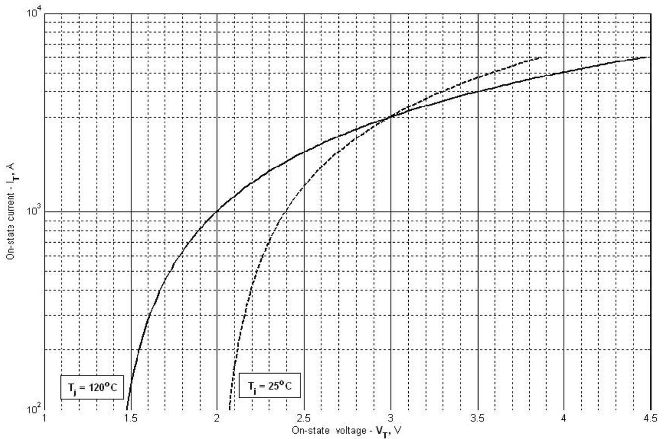
**Рис. 1 – Вольт – амперная характеристика в открытом состоянии**
