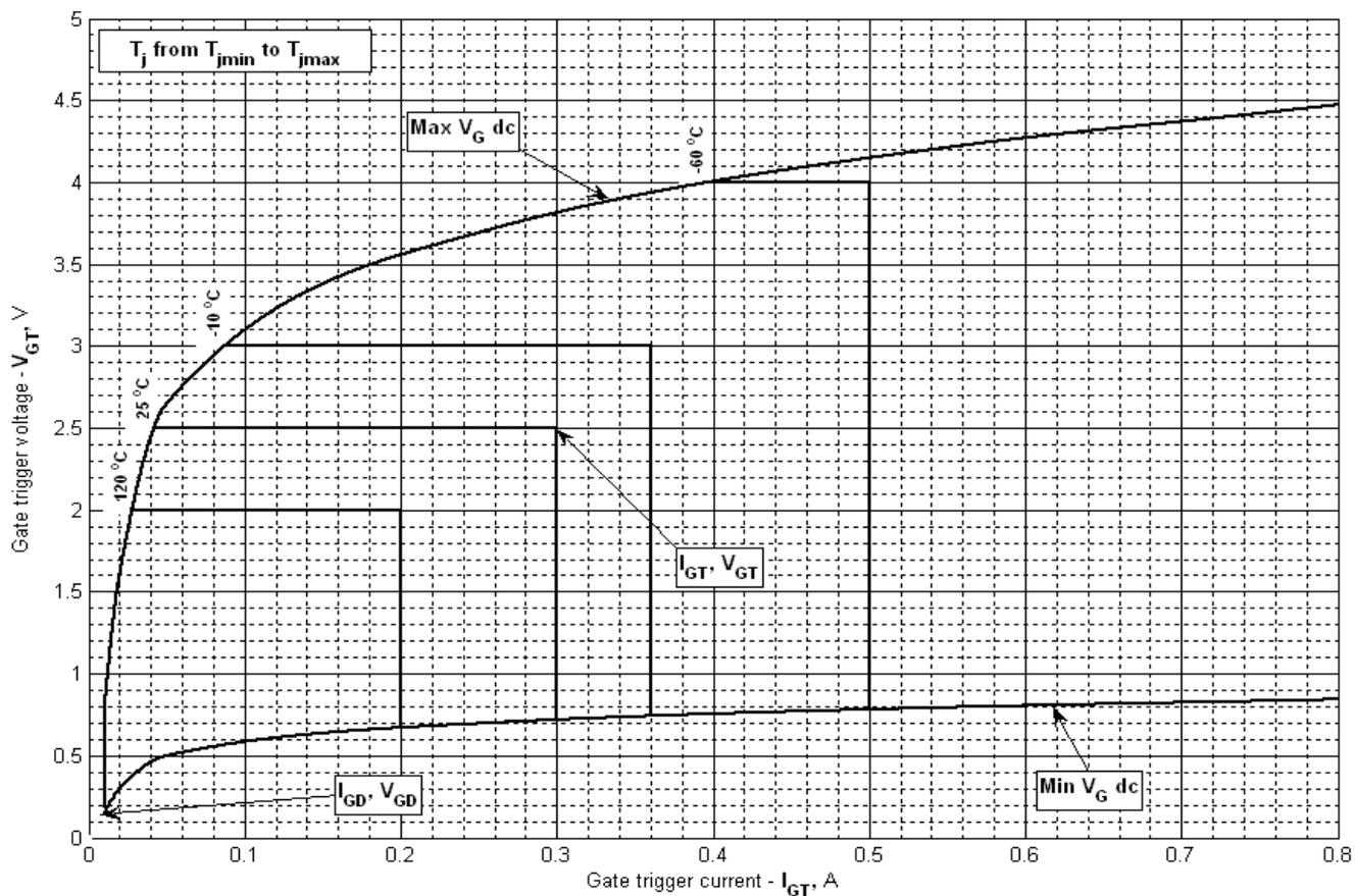
Рис. 3 - Вольт — амперная характеристика цепи управления
