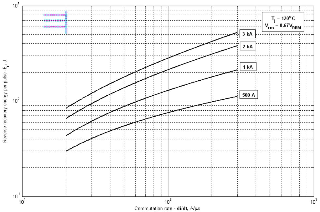
Рис. 9 – Энергия обратного восстановления за импульс
