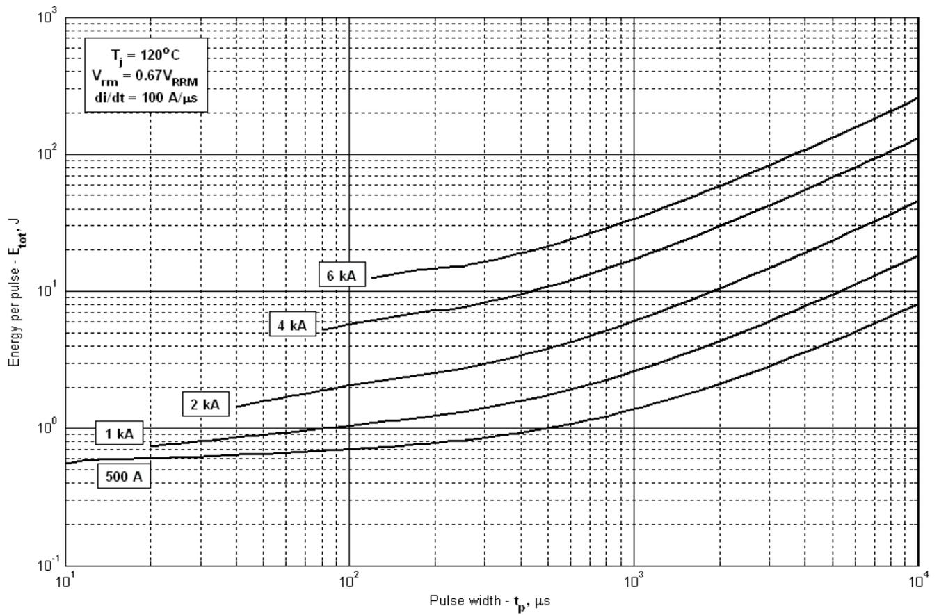
Рис. 26 – Суммарная энергия потерь одного прямоугольного импульса тока
