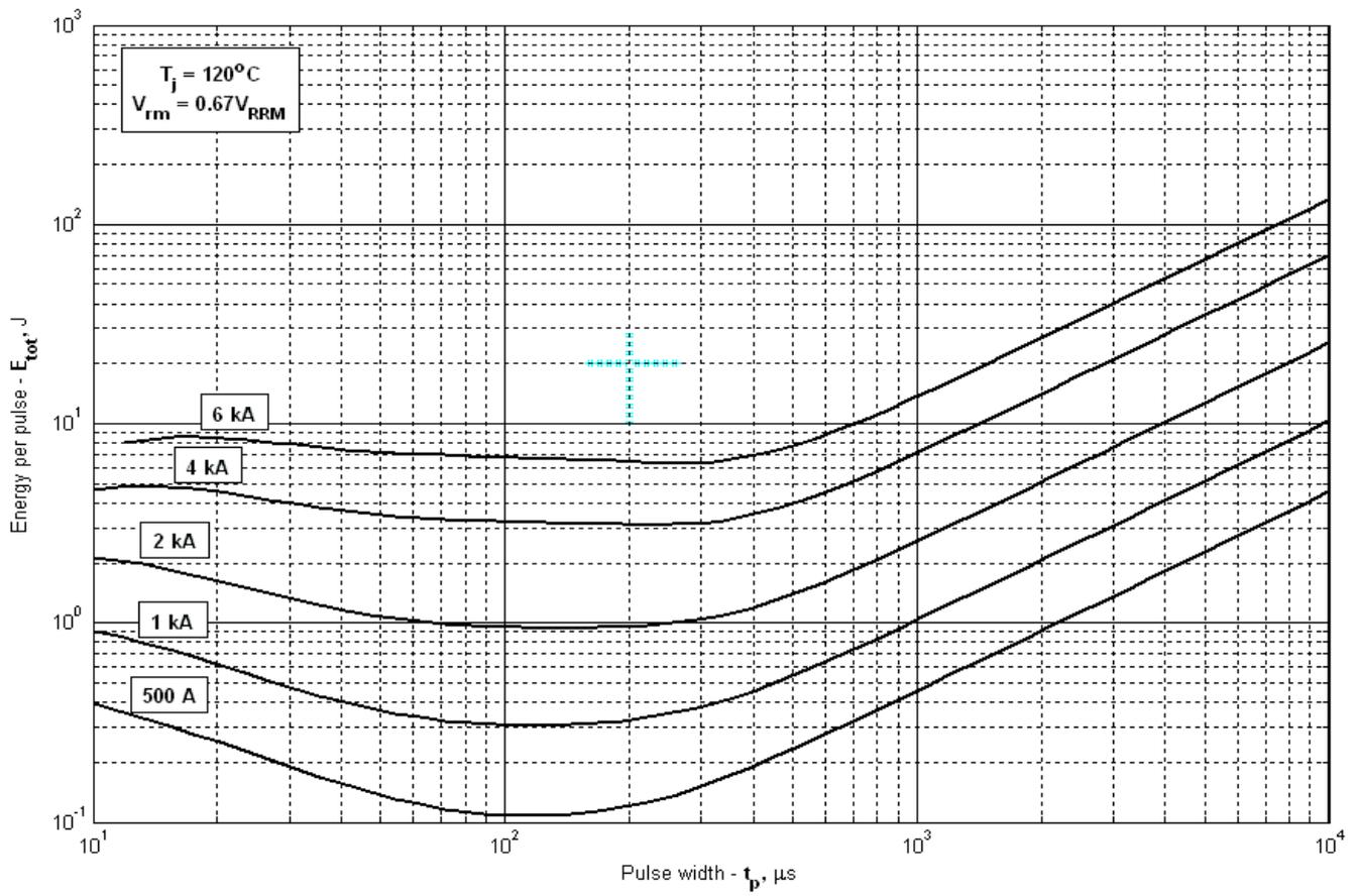
Рис. 11 – Суммарная энергия потерь одного синусоидального импульса тока
