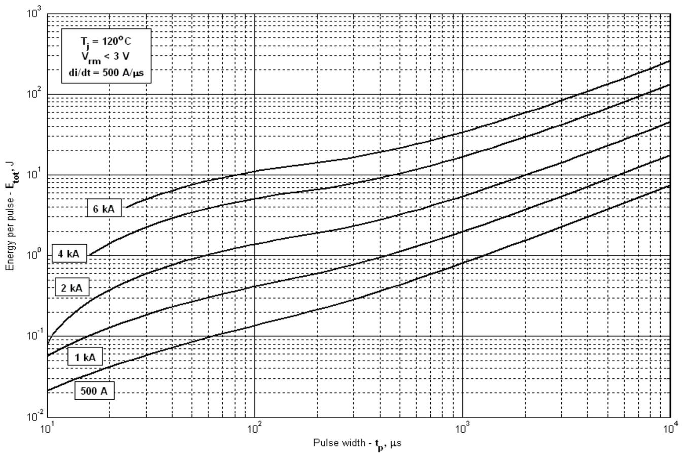
Рис. 21 – Суммарная энергия потерь одного прямоугольного импульса тока
