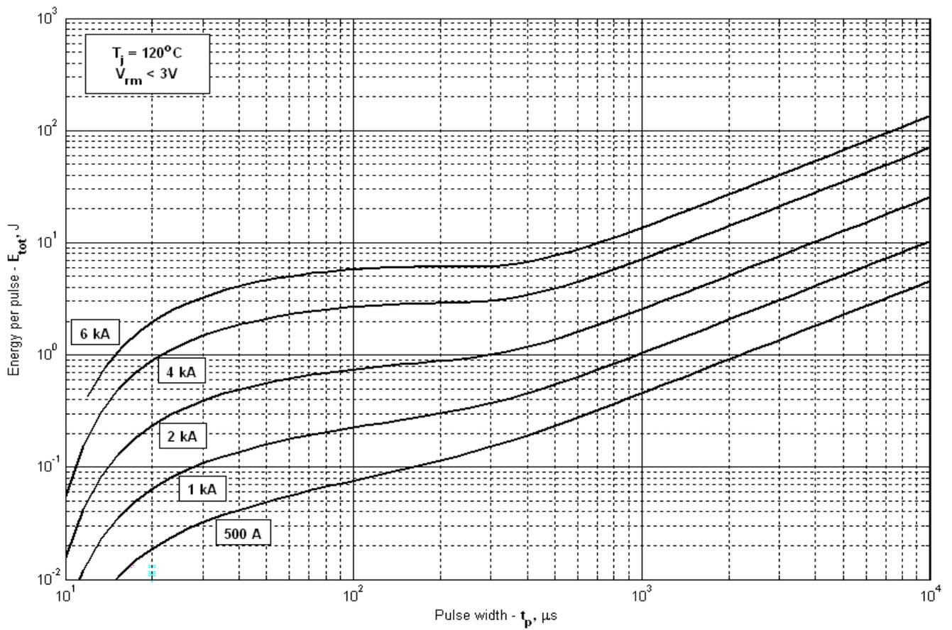
Рис. 10 – Суммарная энергия потерь одного синусоидального импульса тока
