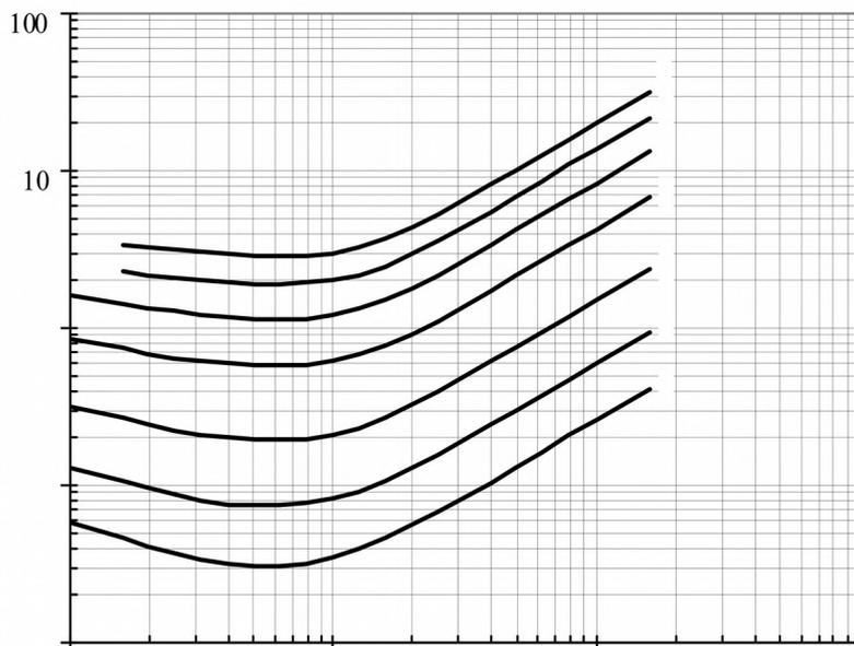
**Рис. 23** – Зависимость энергии потерь за один синусоидальный импульс тока от длительности импульса
